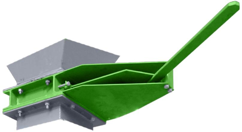
Золотниковый затвор SPA предназначен для закрывания разгрузочных воронок и аккумулирующих баков сыпучих неклеящих порошковых материалов. Применяются в местах, доступных для ручного обслуживания с помощью рычага. Затвор состоит из рамы из прокатных профилей с листом из листовой стали толщины 6,0мм. Лист уплотнён от окружающей среды графитным сальником и направляются в раме в стальных планках.
